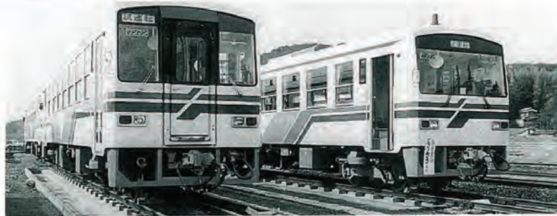
座席52人、立席50人、合計102人、乗で最高速度95km/h、ワンマン運転用に開発されたディーゼル動車で冷暖房を設備。
