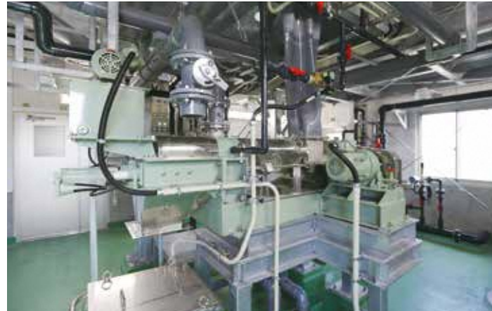
きょう雑物脱水装置(1階) きょう雑物(ごみ)を脱水して施設の外へ運び出します。
