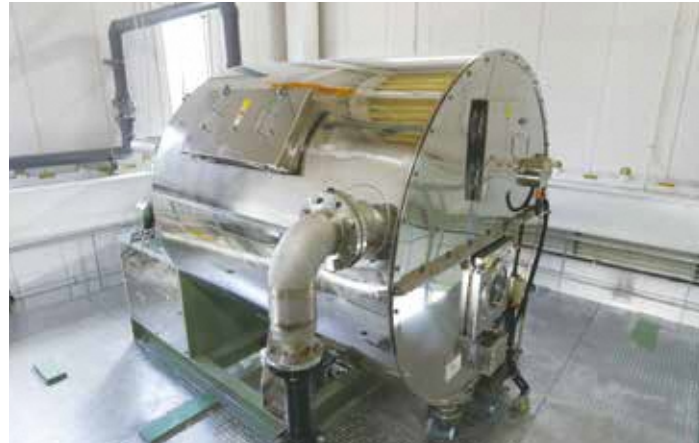
きょう雑物除去装置(2階) し尿・浄化槽汚泥に含まれるきょう雑物(ごみ)を取り除きます。
